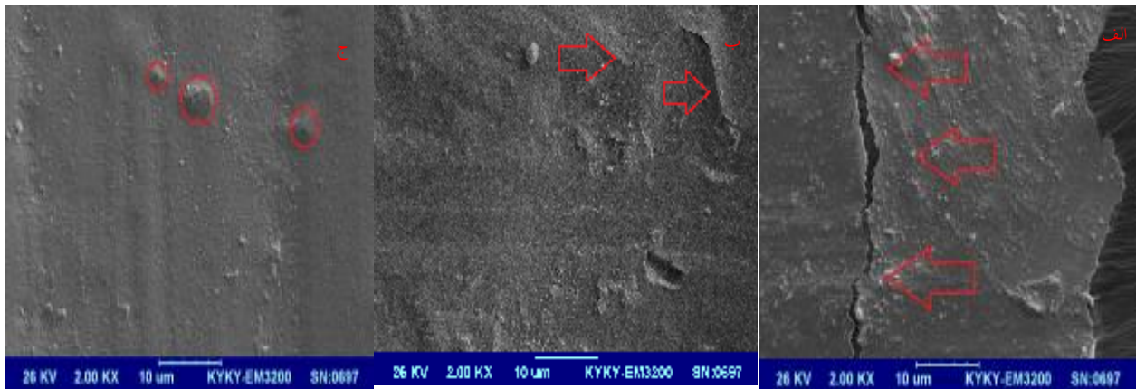
تصویر 2- تصاویر میکروسکوپ الکترونی بعد از فرآیند تخریب پذیری: الف) نمونه 1103 بعد از گذشت 105 ساعت. ب) نمونه‌های 1000 بعد از 460 ساعت. ج) نمونه 1051 بعد از 460 ساعت.
